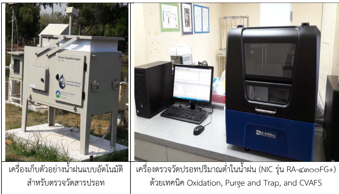
รูปที่ ๓.๔ เครื่องเก็บน้ำฝนอัตโนมัติและเครื่องวิเคราะห์ตัวอย่างสารปรอทในน้ำฝน
